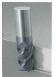
肩削りのアドバイス ap (切断長さ全体を使用する) ae (半径方向の切断深さ) 最大0.1×D
