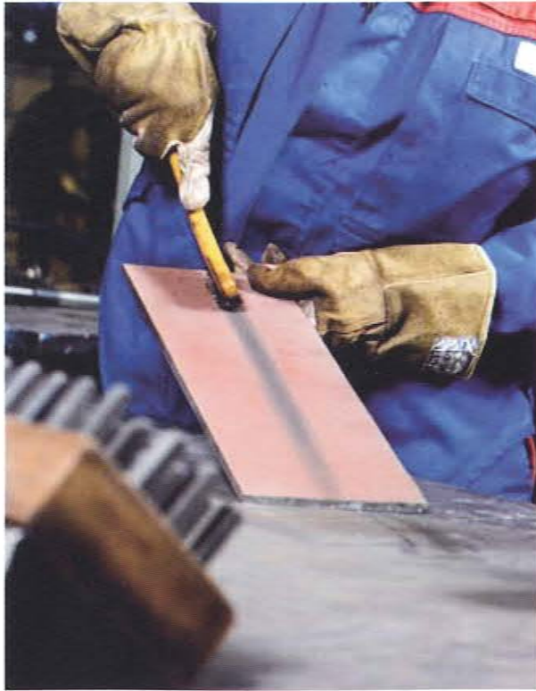
プライマーを除去すれば、さらによりよい溶接結果が得られます。
